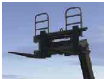
Forks with hydraulic side-shift Forche con traslatore idraulico
